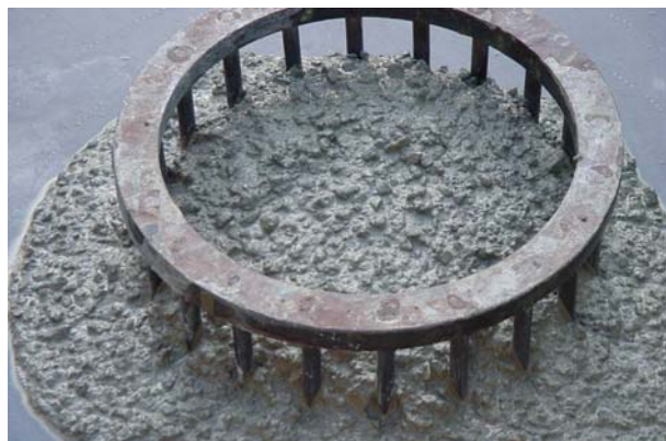
Hormigón autocompactable recién vertido
